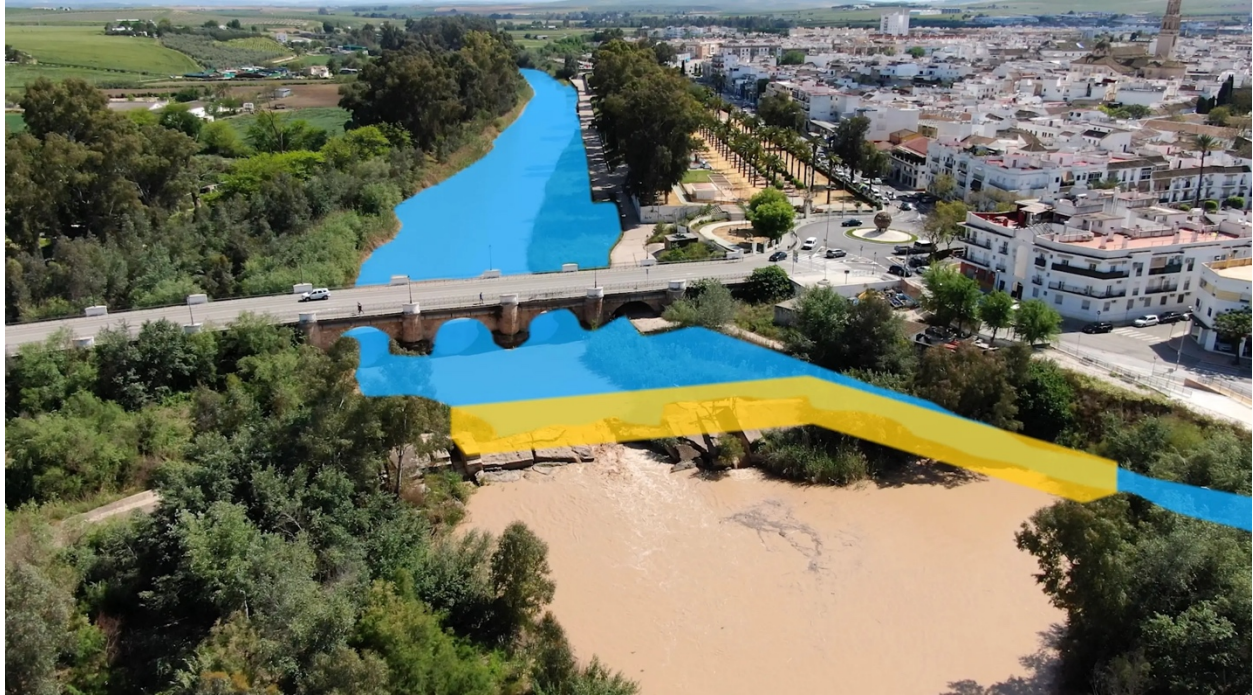
En la imagen, la restauración del azud derivará parte del caudal del Genil al Meandro de San Francisco
